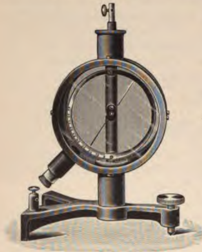
Abb. 30. Elektrometer nach Braun.
